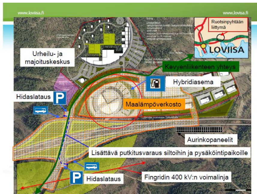
Kuva 7 Kaaviokuva Vihreälle moottoritiele E18 suunnitellusta hybridiasemasta [17]
